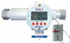
с корректором, функцией передачи данных и управления клапаном в системе со смарт-картой и дополнительного контроля датчика загазованности. Перекрытие газа по мере срабатывания датчика загазованности либо расходования оплаченного объема газа.
