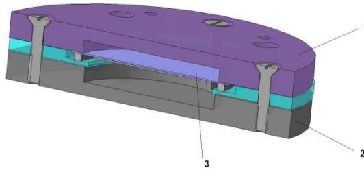
Рисунок 2 – Пьезодатчик
