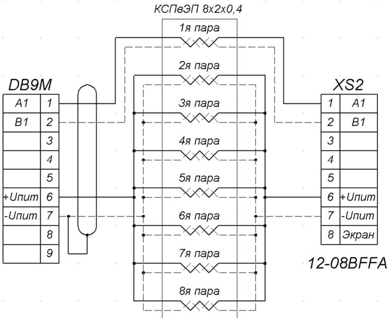
Рисунок И.2. Схема распайки кабеля КСПвЭП 8×2×0,4
