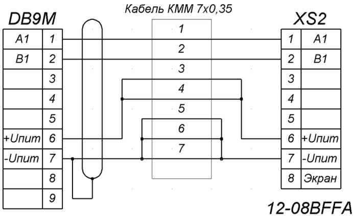
Рисунок И.1. Схема распайки кабеля КММ 7×0,35
