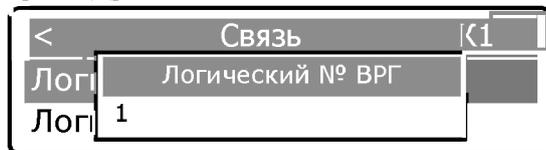
Ввод параметра осуществляется с помощью повторного нажатия клавиши [ВВОД], после чего активная цифра выделяется подчеркиванием (режим редактирования). Изменение значений – клавишами [0]-[9], перемещение между цифрами – с помощью клавиш [←] [→].
