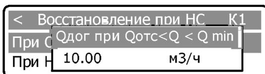
**ВНИМАНИЕ!** Значение параметра «При Q < Q<sub>min</sub>» должно быть меньше или равно «Q<sub>min</sub>».
