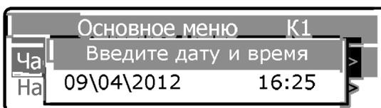
В открывшемся окне установить текущую дату и время. Переключение в режим редактирования осуществляется с помощью повторного нажатия клавиши [ВВОД]. Установка времени / даты осуществляется с помощью клавиш [ 0 ] - [ 9 ], перемещение между цифрами – с помощью клавиш [ ← ] [ → ]. Активная цифра выделяется подчеркиванием. Для подтверждения введенных значений нажать [ВВОД]. На дисплей выводится сообщение об изменении параметра.
