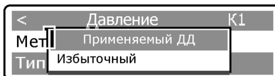
Повторным нажатием клавиши [ВВОД] активизируется режим выбора типа датчика:
