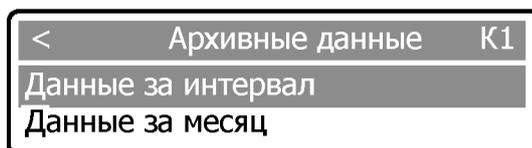
В открывшемся окне установить дату и время начала отчетного периода. Установка времени / даты осуществляется с помощью клавиш [ 0 ] - [ 9 ], перемещение между цифрами – с помощью клавиш [ ← ] [ → ]. Активная цифра выделяется подчеркиванием.
