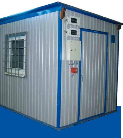
Шкаф узла учета газа предназначен для размещения элементов узла учета газа и поддержания в объеме шкафа заданной положительной температуры воздуха при пониженной (ниже +10) температуре окружающей среды.
